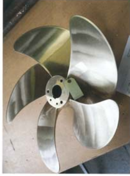
Überholer und exakt vermessener Propeller eines DG/RIS-Rettungsbootes mit Vermessungsprotokoll
