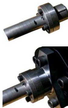
Setzen Sie den Klemmflansch in die Kupplung ein und anschließend die Welle bis zur Markierung in den Klemmflansch.
