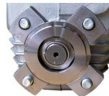
Legen Sie nun den Zentrierring wie nachstehend gezeigt auf die Montagefläche der Kupplung auf und drücken diesen in das Kupplungselement. Nötigenfalls unter Zuhilfenahme von Hammer und Schlagholz. Das Einsetzen bedarf nur einem geringen Kraftaufwand, wenn der Zentrierring zuvor exakt positioniert wurde.
