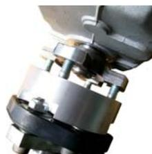
Anschließend stecken Sie die Kupplung auf den Getriebeflansch und drehen die Befestigungsmuttern handfest auf.
