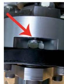
**Demontage:** um den Klemmflansch zu lösen, entfernen Sie die Inbusschrauben und setzen Sie in die zwischenliegenden Gewindebohrungen ein. Durch gleichmäßiges, abwechselndes Eindrehen der Bolzen löst sich der Klemmflansch. Die Demontage kann in umgekehrter Reihenfolge der Montage fortgesetzt werden.
