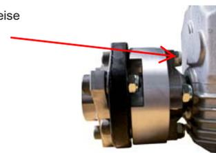
**Die Montage ist damit abgeschlossen.** Drehen Sie abschließend die Kupplung per Hand um eine volle Umdrehung um den einwandfreien Lauf zu kontrollieren. **Die in der Aussparung sitzenden Bolzen dürfen den gegenüberliegenden Körper nicht berühren, ansonsten ist dies ein Beleg dafür, dass Sie bereits jetzt den max. Ausgleichswinkel von 3° überschritten haben.**
